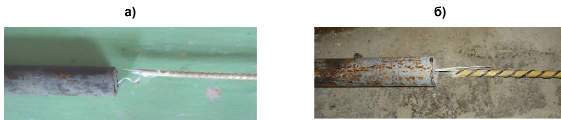
Рисунок 3. Характер разрушения образцов ПКА малых диаметров: разрыв стержня происходит мгновенно в месте сопряжения стержня с анкером
