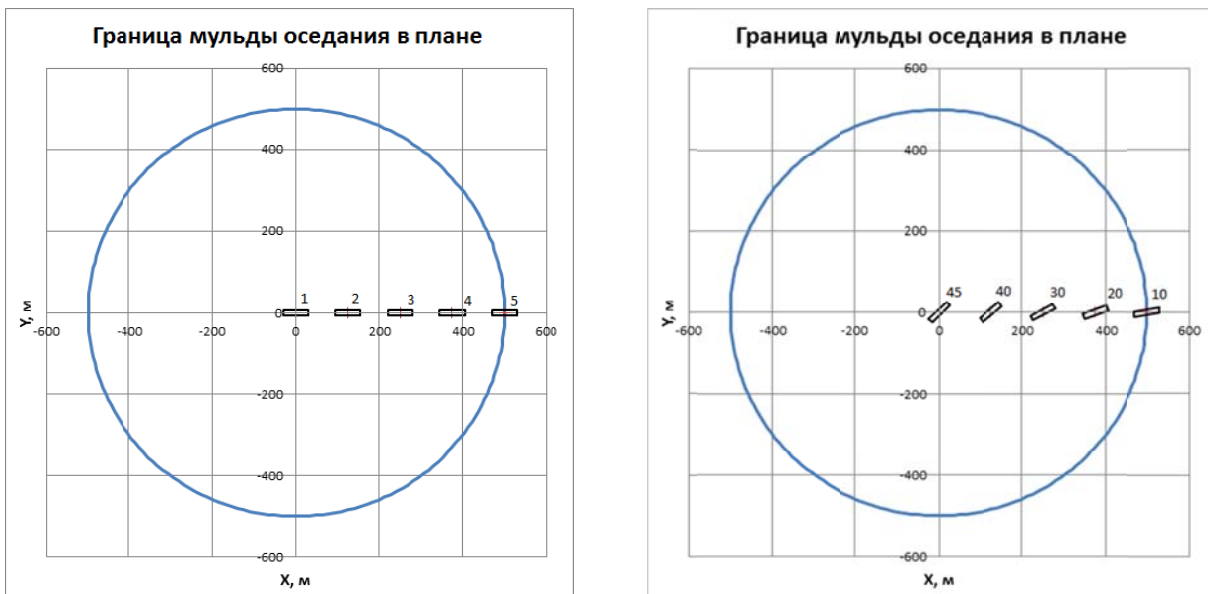
Рисунок 11. Положения здания в мульдe оседания
