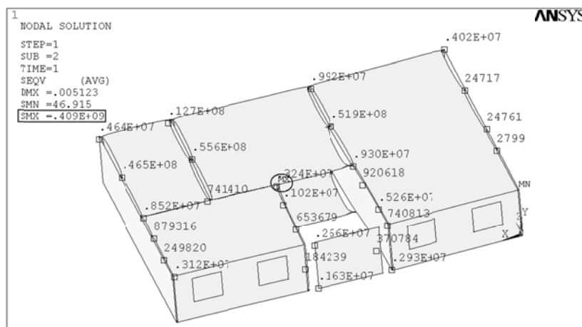
Рисунок 18. Эквивалентные напряжения в стыках при растяжении (линейный расчет)
