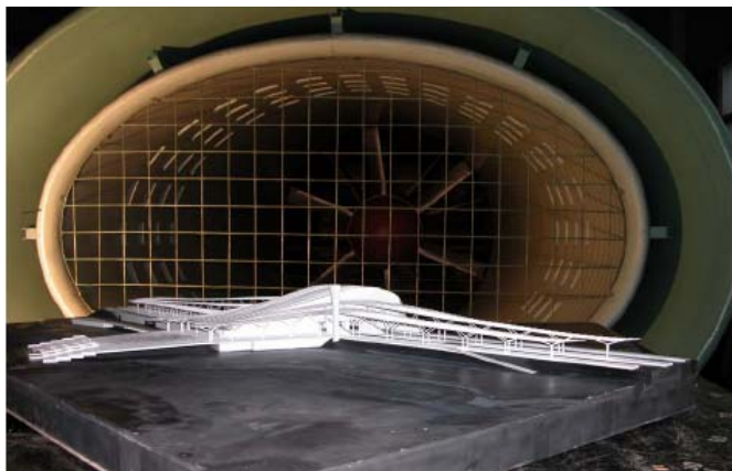
Рисунок 1. Макет здания вокзала в аэродинамической трубе
