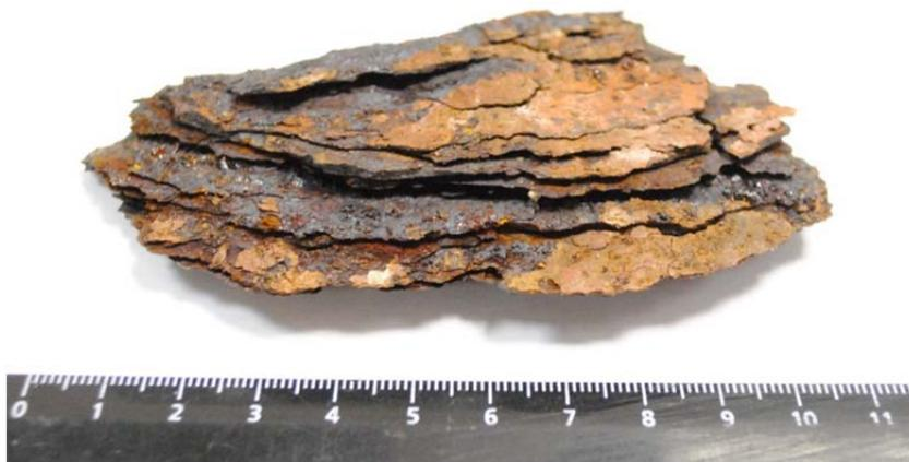
**Рисунок 6. Слоистые коррозионные окислы, отобранные с балок перекрытия**
