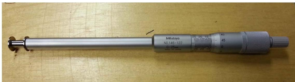
**Рисунок 4. Микрометр-толщиномер**
