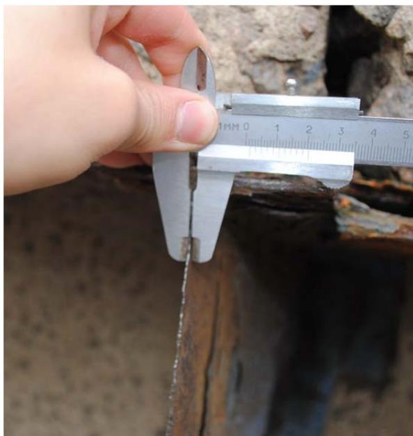
**Рисунок 2. Измерение остаточной толщины штангенциркулем**
