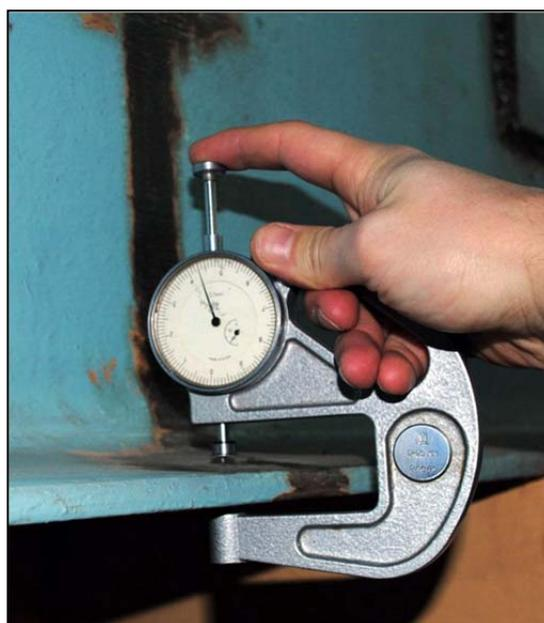
**Рисунок 3. Измерение остаточной толщины ИЧТ со скобой**
