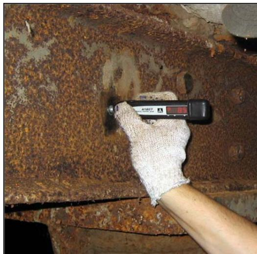
**Рисунок 5. Измерение толщины с помощью ультразвукового прибора**
