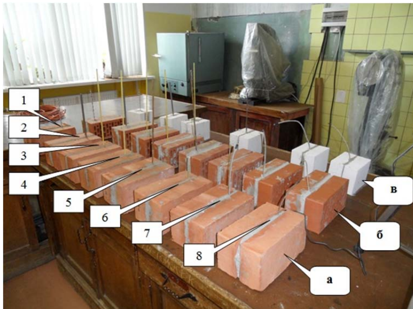
Рисунок 6. Вид испытанных образцов анкеров, выдерживаемых из кирпичных растворных швов (а – полнотелый кирпич и б – пустотелый кирпич) и клеевого слоя кладки из газосиликатных блоков (в):
