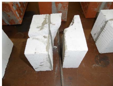
Рисунок 7. Пример разрушения образца из газобетона
