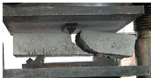
Рисунок 6. Характер разрушения бетонных призм, усиленных углеволокном
