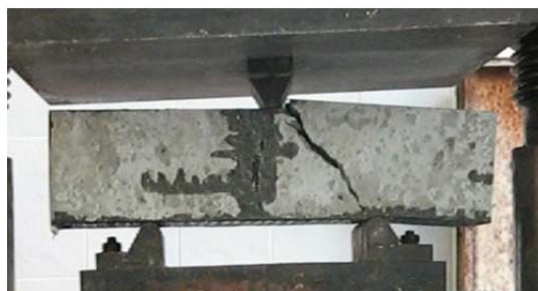
Рисунок 9. Характер разрушения бетонных призм, восстановленных и усиленных углеволокном
