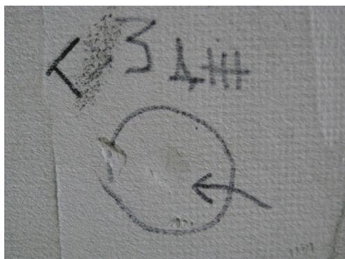
а) Ударная прочность  $< 3$  Дж. Трещина в месте удара
