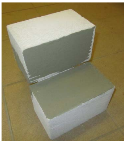
Рисунок 7. Характер разрушения образцов из ячеистобетонных блоков на тонких растворных швах
