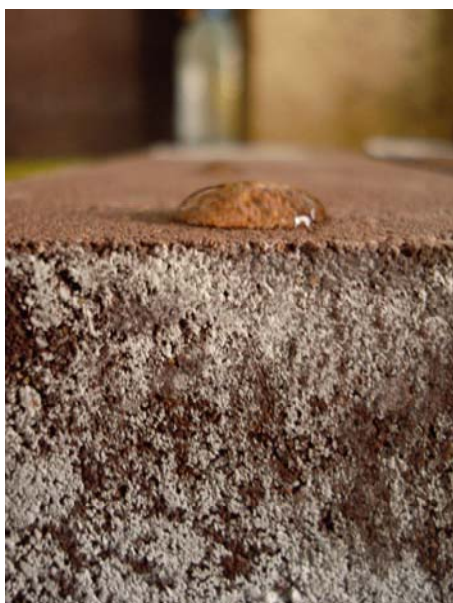
Рисунок 11. Блокировка высолообразования на поверхностях вибропрессованных бетонных блоков гидрофобизаторами Гидрощит-супер и Типром К Люкс, нанесенными непосредственно по высолом
