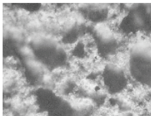
Рисунок 1. Микрофотография структуры теплоизоляционной керамики из массы состава 3
