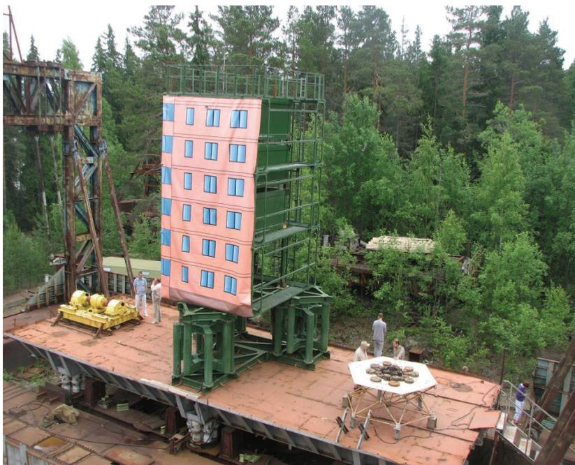
**Рисунок 4. Вид сейсмоплатформы с макетом сейсмоизолированного здания и установленной вибромашиной**
