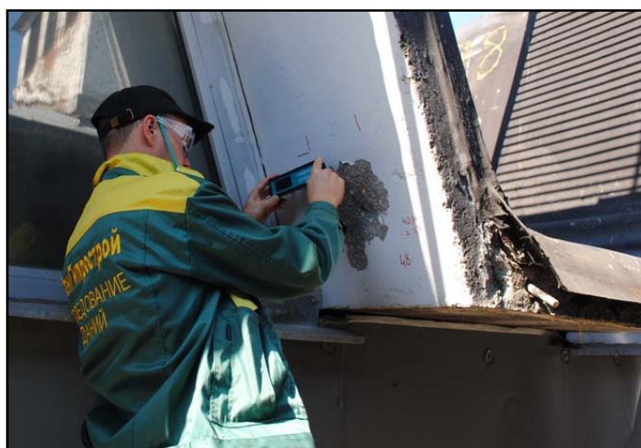
Рисунок 5. Измерение удельного электрического сопротивления бетона стенки складки
