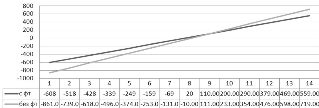
Рисунок 5. График распределения напряжений NY в конструкциях сейсмоизолированного здания и здания без изоляции [Т/м<sup>2</sup>]
