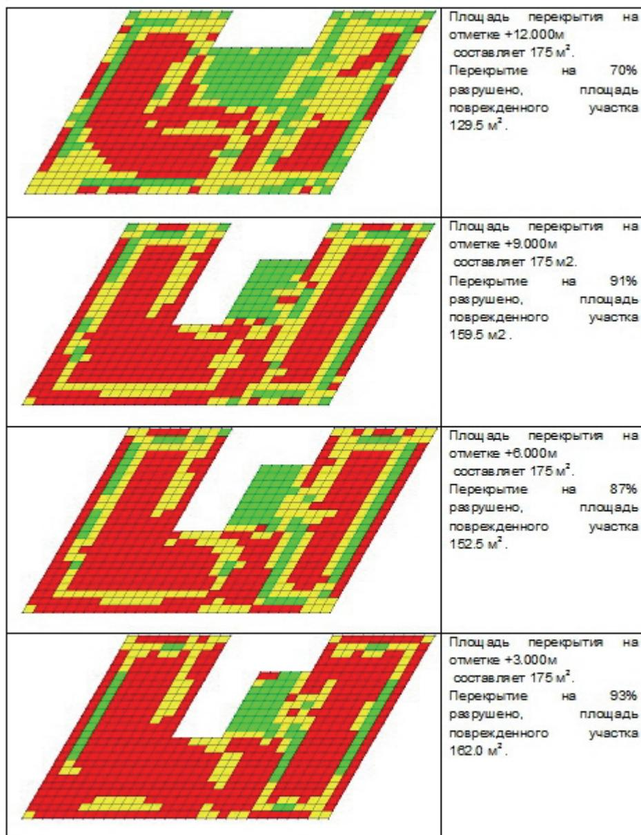
Рисунок 6. Расчет несейсмоизолированного здания на прогрессирующее обрушение
