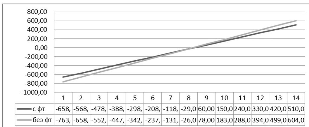
Рисунок 4. График распределения напряжений NX в конструкциях сейсмоизолированного здания и здания без изоляции [Т/м<sup>2</sup>]
