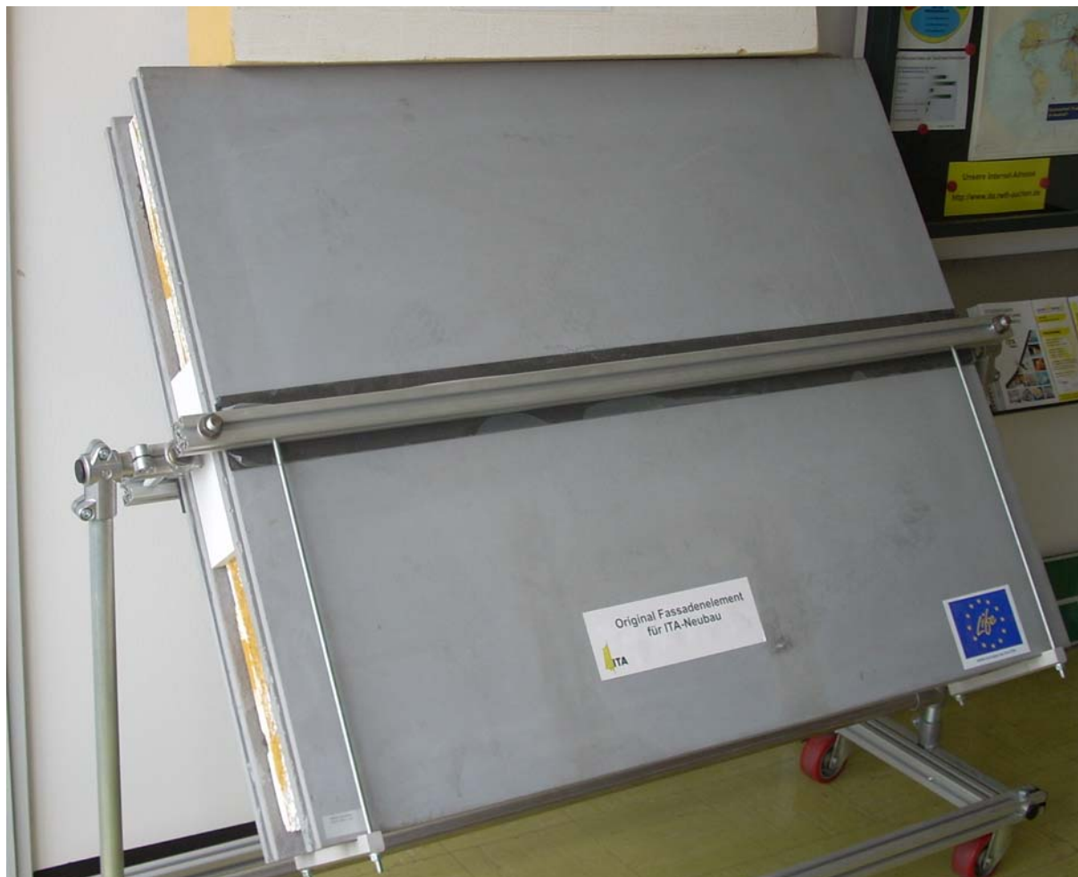
Рисунок 4. Стеновая панель, в которой ограждающими наружными и внутренними слоями являются тонкостенные текстильно-армированные бетонные плиты (сэндвич-панель)
